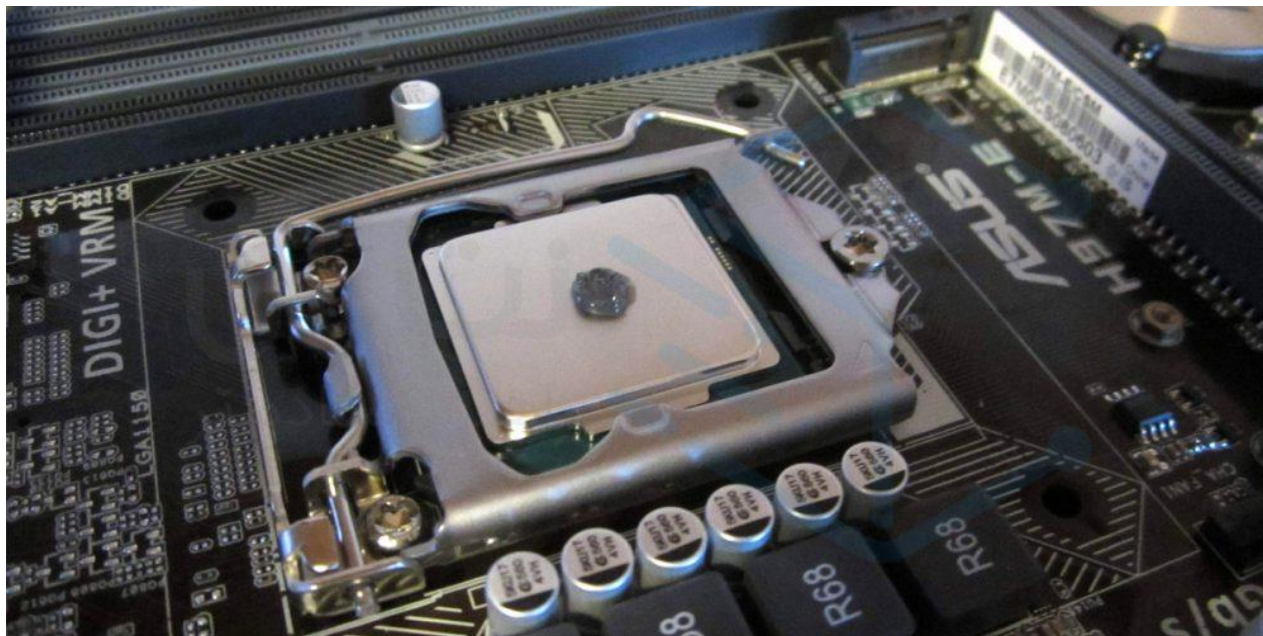
تصویر ۳- خمیر سیلیکونی روی CPU
