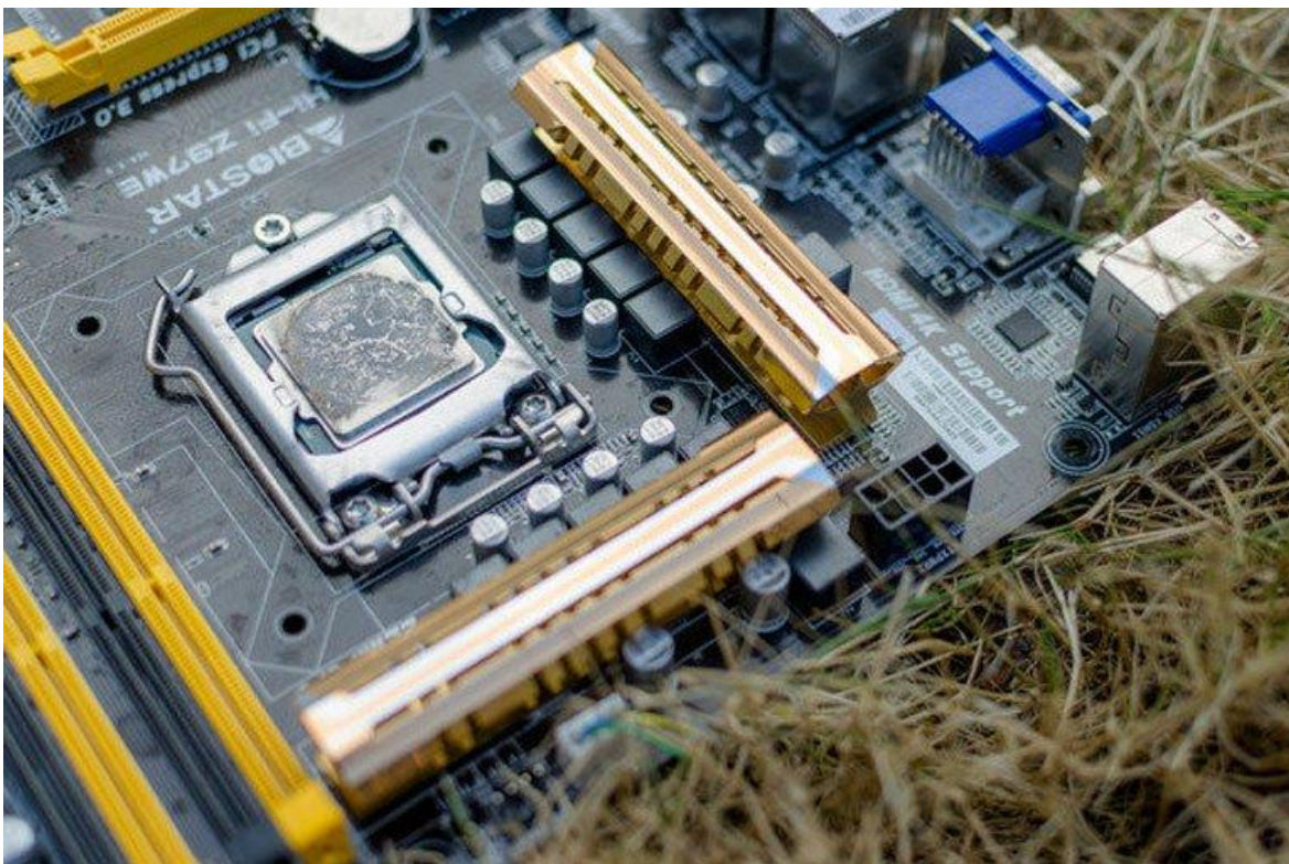
تصویر ۲- قرار دادن سی‌پی‌یو در سوکت
