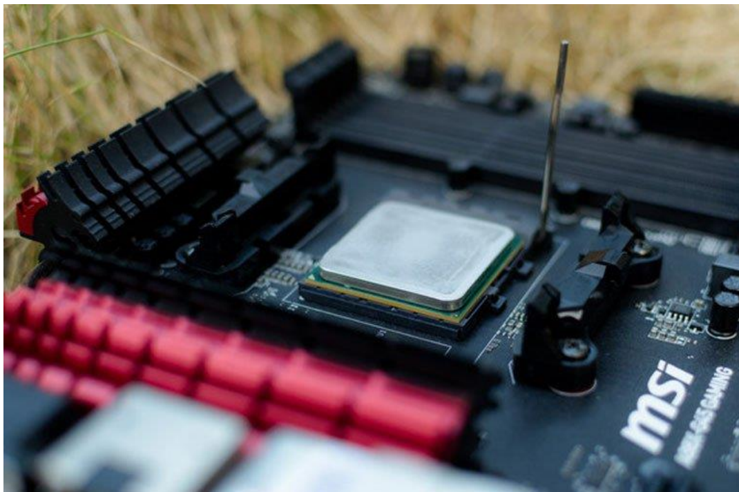
تصویر ۷- نصب پردازنده‌ی AMD روی سوکت
